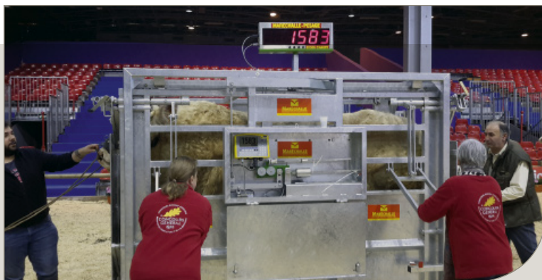
PM 1200 Renforcé utilisé pour la pesée officielle des bovins lors du Salon International de l'Agriculture à Paris.
