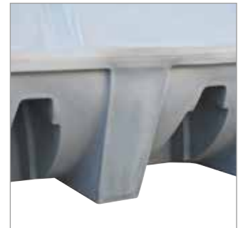
Bat-flots intégrés dans le moulage des citernes évitant les mouvements d'eau lors du transport, le nombre variant en fonction du litrage.
