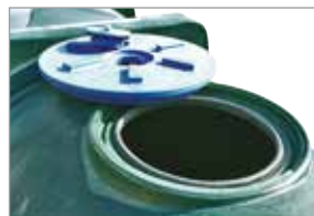
Large couvercle Ø 600 mm rotomoulé avec en son centre, un bouchon évent Ø 120 mm. Permet un passage d'homme aisé de Ø 500 mm pour les actions de nettoyage ou de maintenance
