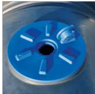
Large couvercle Ø 600 mm rotomoulé avec en son centre, un bouchon évent Ø 120 mm. Permet un passage d'homme aisé Ø 500 mm pour les actions de nettoyage ou de maintenance.
