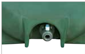
Vanne complète femelle/mâle 50/60 (2") montée sur bride renforcée à visser, montée dans un renforcement rotomoulé dans la masse.
