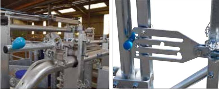
Réglage de la largeur choisie simple par une poignée en partie supérieure.
