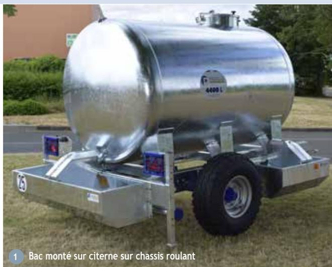
1 Bac monté sur citerne sur châssis roulant
