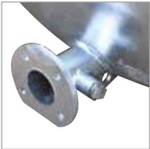
Sortie arrière principale Ø 80 mm (3" 1/8) sur platine 4 trous prévue pour la fixation des options vannes et d'une sortie Ø 20/27mm (3/4") femelle fileté sur le côté de la sortie principale.
