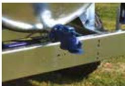
Vanne droite à boisseau Ø 60 mm sur bride. Se fixe sur la sortie arrière des citernes pré-disposées pour la recevoir. Livrée avec joint et plaque d'épandage démontable.
