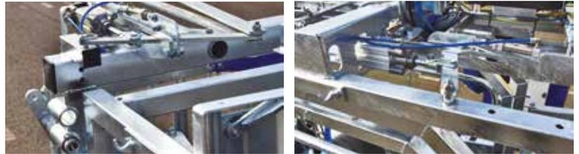
Vérins pneumatiques fonctionnant sur une pression de 5 bars. Diamètre des vérins étudié en fonction des efforts à opérer pour l'ouverture de chaque élément. Chacun des éléments manipulés par les vérins est équipé de sécurité mécanique à butée franche permettant de limiter les efforts et casses des vérins, notamment lors de poussées animales.
