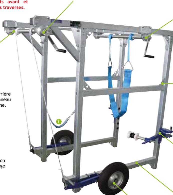
Treuil pour sangle sous-ventrière Lg. 1450 x l.150 mm polyester avec triangles, manoeuvrée par un moulinet auto-freiné.
