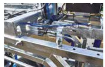
Vérins pneumatiques fonctionnant sur une pression de 5 bars. Diamètre des vérins étudié en fonction des efforts à opérer pour l'ouverture de chaque élément. Chacun des éléments manipulés par les vérins est équipé de sécurité mécanique à butée franche permettant de limiter les efforts et casses des vérins, notamment lors de poussées animales.
