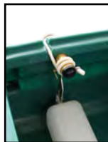
avec un câble chauffant autour du flotteur
